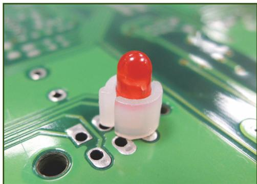
用途：用于保护LED灯矗立在PCB板上，使LED灯高度一致，接脚不会、弯曲、折断、短路
