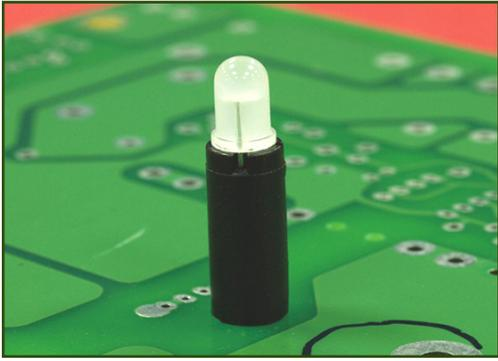
用途：固定4pin Ø5mm的LED灯焊在PCB板上，保持LED灯高度一致，有定位脚，不倾斜。
