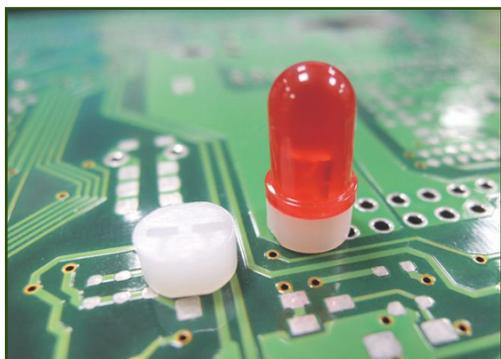
用途：使 LED灯立于PCB板上，高度一致，不断脚。
