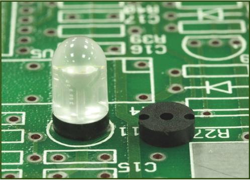
用途：使LED灯直立于PCB板上，高度一致，不断脚
