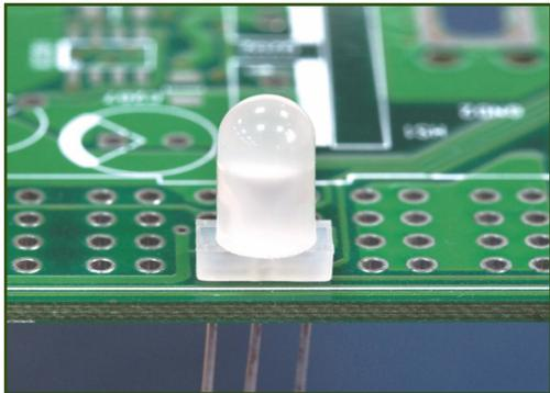
用途：保护LED灯固定在PCB板上，使LED灯接脚不会弯曲、折断、短路，并使LED灯高度一致。
